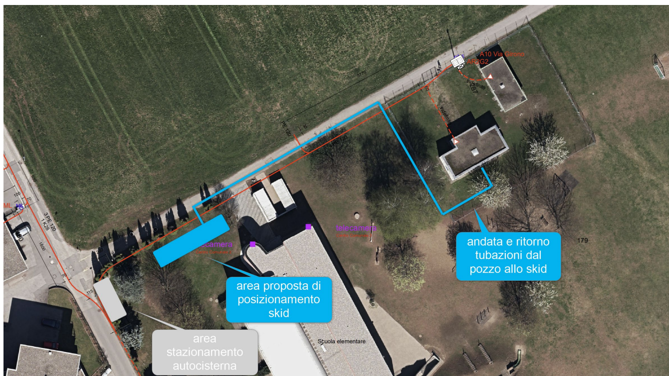
Figura 6: identificazione dell'area di installazione
